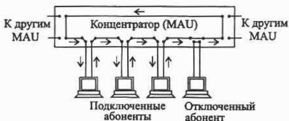
Рис. 5.4. Соединение абонентов сети Token-Ring в кольцо с помощью концентратора (MAU)
