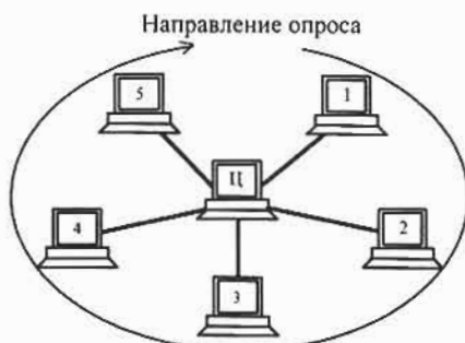
Рис. 3.5. Централизованный метод управления обменом в сети с топологией «звезда»
