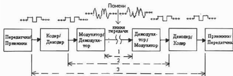
Рис. 12.1. Общая структурная схема канала передачи: 1 — непрерывный (аналоговый) канал; 2, 3 — дискретные каналы
