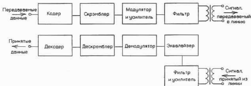
Рис. 12.4. Структурная схема модема
