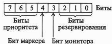
Рис. 5.9. Формат байта управления доступом
