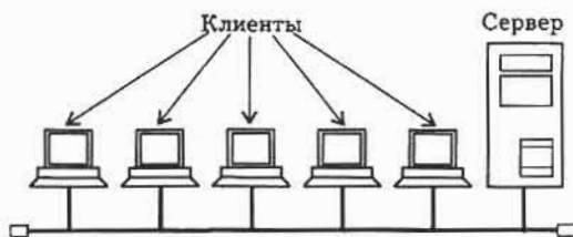
Рис. 4.14. Сеть на основе сервера
