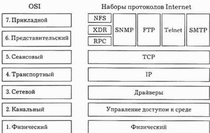
Рис. 4.9. Соотношение уровней модели OSI и протоколов сети Internet
