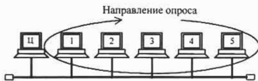
Рис. 3.6. Централизованное управление в сети с топологией «шина»
