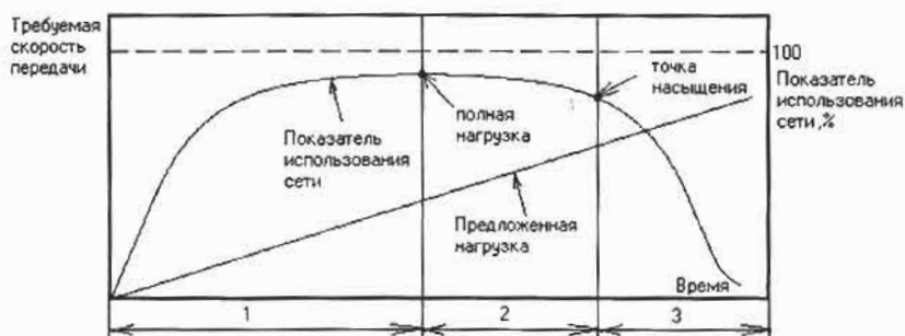
Рис. 7.2. Зависимость показателя использования сети от времени при линейном увеличении предложенной нагрузки (1 – наилучшая область работы, 2 – приемлемая, 3 – плохая)
