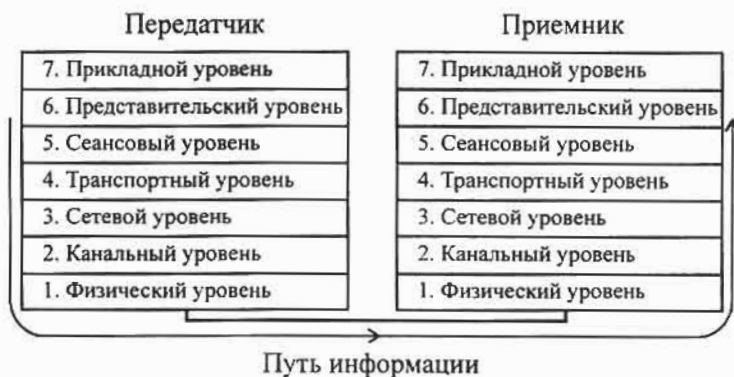
Рис. 4.2. Путь информации от абонента к абоненту
