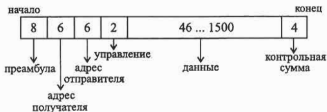
Рис. 5.2. Структура пакета сети Ethernet. (цифры показывают количество байт)
