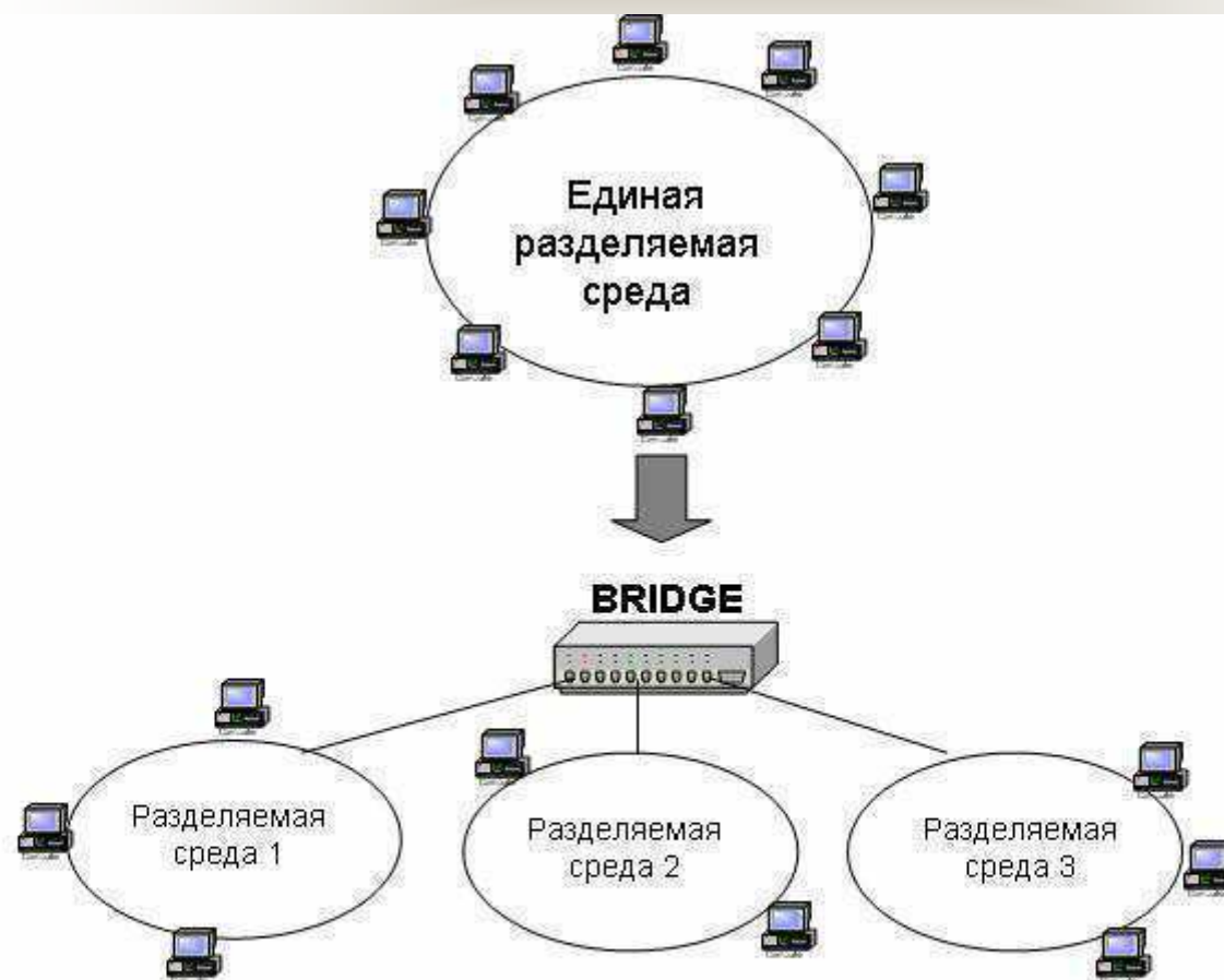
Рис.2.37. Разделение разделяемой среды. Bridge divides shared media.
